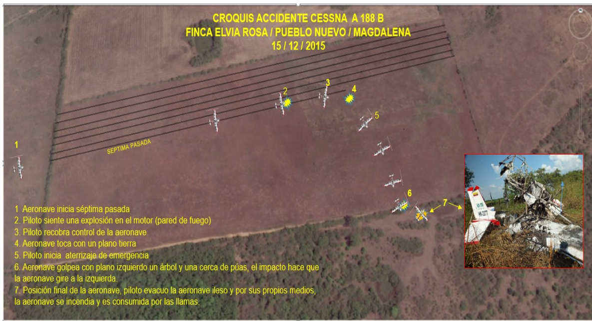
Imagen No. 4 – Diagrama del aterrizaje forzoso
