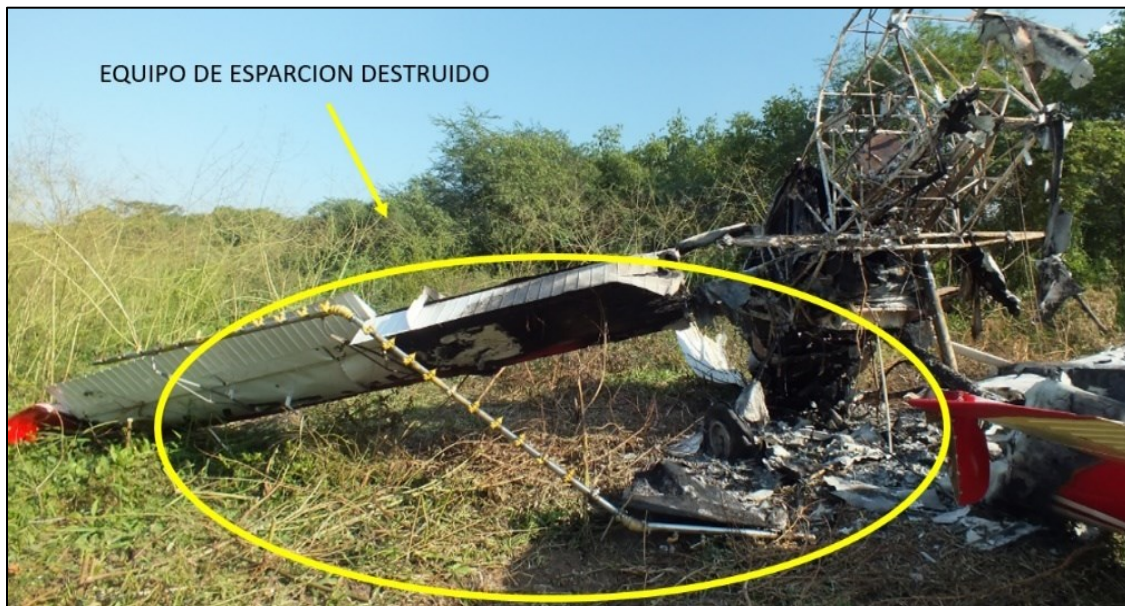
Imagen No. 12 - Equipo de aspersión destruido del HK2277
