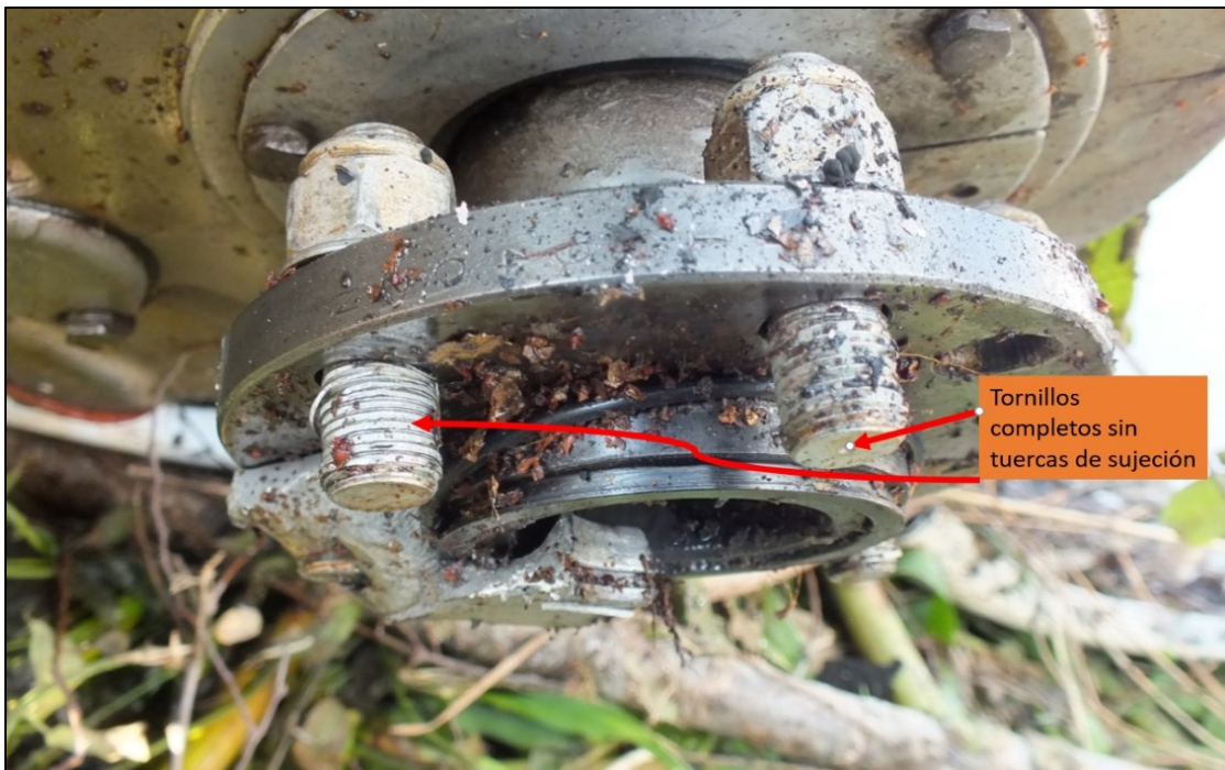
Imagen No. 9: Flache del cigüeñal del motor, roto.
