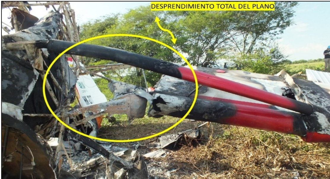
Imagen No. 8 - Daños totales del fuselaje y desprendimiento de planos HK2277.
